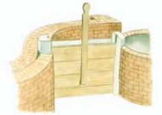
Dettaglio della paratoia in legno utilizzata per la regolazione del flusso dell'acqua
