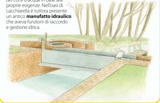
Dettaglio della paratoia in legno utilizzata per la regolazione del flusso dell'acqua
